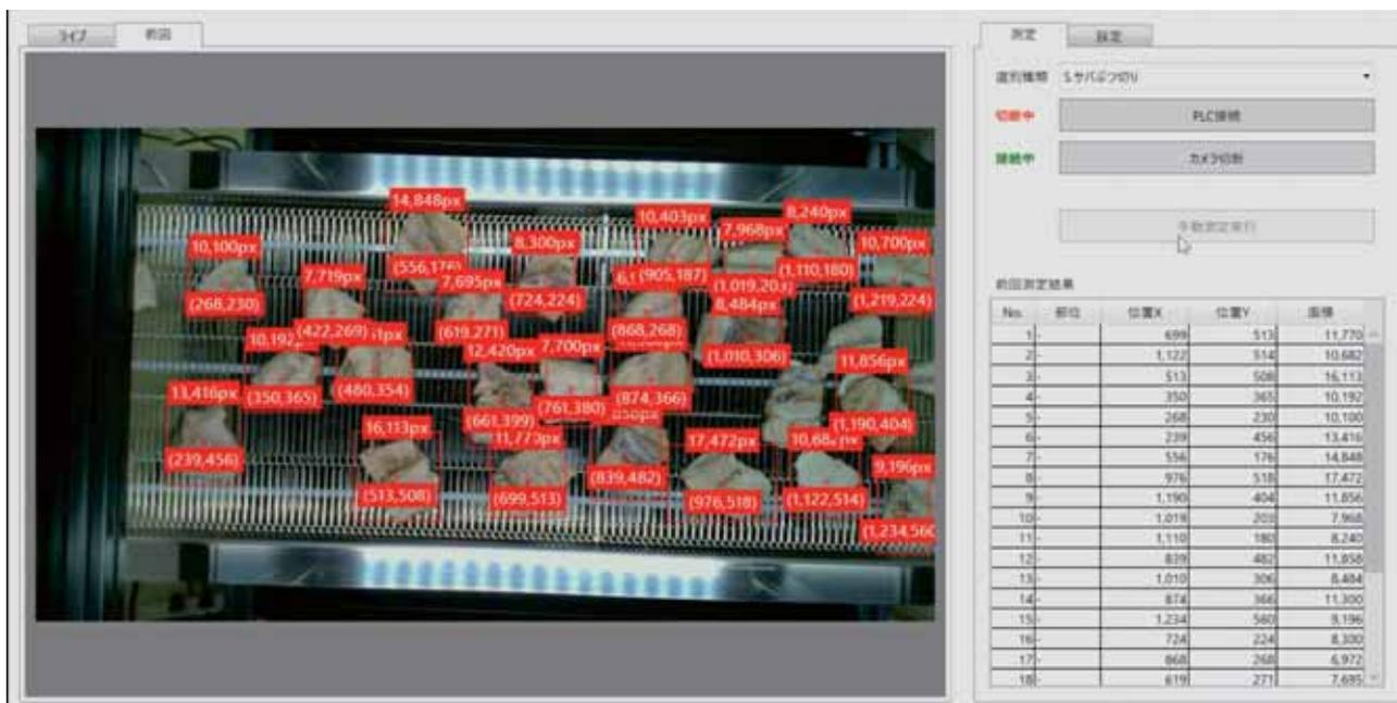
(コンベア上をサバの焼成切身が流れているところ。座標と面積を確実に捉えている。)
