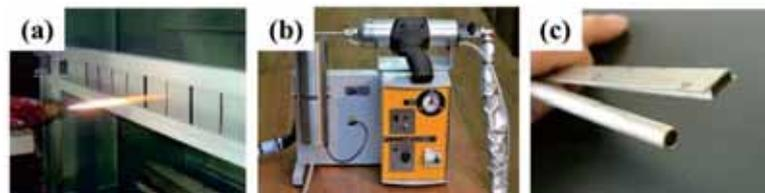
図3 溶射装置外観の写真 (a: 高速フレイム溶射, b: コールドスプレー装置) とコールドスプレー装置のノズル(c)
