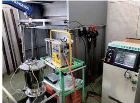
図7 ディスク式粉末供給装置
