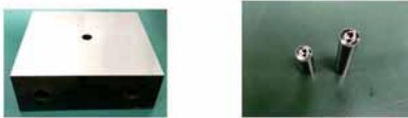
図 5 球形芯異材料成形金型の写真、ダイ（左）、パンチ（右）
