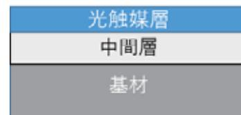
図9 中間層形成した光触媒プレートの構造
